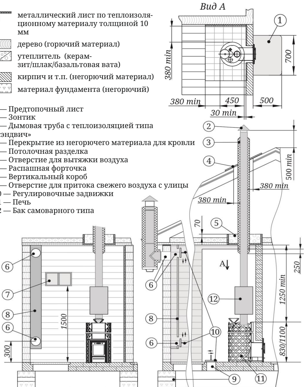
Рисунок 3. Схема монтажа печи
