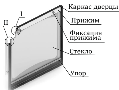
Рисунок 6. Ремонт светопрозрачного экрана дверцы «Люмина»
